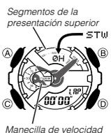
Puede usar el cronógrafo para medir el tiempo transcurrido, los tiempos de vuelta y los tiempos fraccionados. Si especifica un valor de distancia, el cronógrafo también calculará y visualizará las velocidades.
