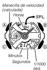
Seleccione la medición del tiempo fraccionado (**SPL**) y luego realice las siguientes operaciones de los botones.
