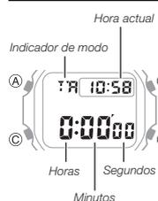
El temporizador de cuenta regresiva puede configurarse dentro de un rango de 1 segundo a 24 horas. Cuando la cuenta regresiva llega a cero, la alarma sonará durante 10 segundos o hasta que usted presione algún botón.
