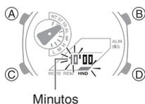
3. Utilice (B) y (D) para cambiar el ajuste de los minutos.
