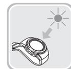
Cuando lleve el reloj puesto, asegúrese de que la manga no bloquee la pantalla (panel solar). La eficiencia en la generación de energía se reduce incluso cuando la pantalla del reloj está bloqueada parcialmente.
