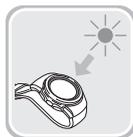
Cuando lleve el reloj puesto, asegúrese de que la manga no bloquee la pantalla (panel solar). La eficiencia en la generación de energía se reduce incluso cuando la pantalla del reloj está bloqueada parcialmente.
