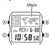
En los modos de indicación de la hora y hora mundial, el mapa muestra la zona correspondiente a la hora digital visualizada en ese momento. En los modos de alarma, temporizador y cronómetro, se muestra la zona correspondiente a la hora de la ciudad local (T-1).
