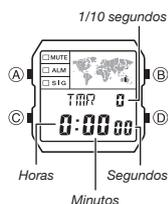
El temporizador de cuenta regresiva puede ajustarse en un rango de un segundo a 24 horas. Suena una alarma cuando la cuenta regresiva llegue a cero.
