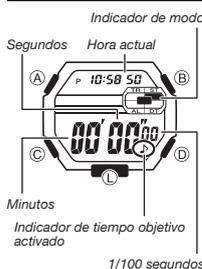
El modo cronómetro le permite medir el tiempo transcurrido, los tiempos fraccionarios, y dos llegadas a meta. El rango del cronómetro es de 23 horas, 59 minutos, 59.99 segundos. También es posible hacer sonar una alarma cuando se alcanza el tiempo objetivo. El modo de cronómetro también cuenta con la función de inicio automático.
