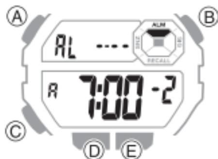
1. En el modo de alarma, utilice (D) para desplazarse a través de las pantallas de alarma hasta que se visualice la pantalla de alarma cuya hora desea ajustar.
