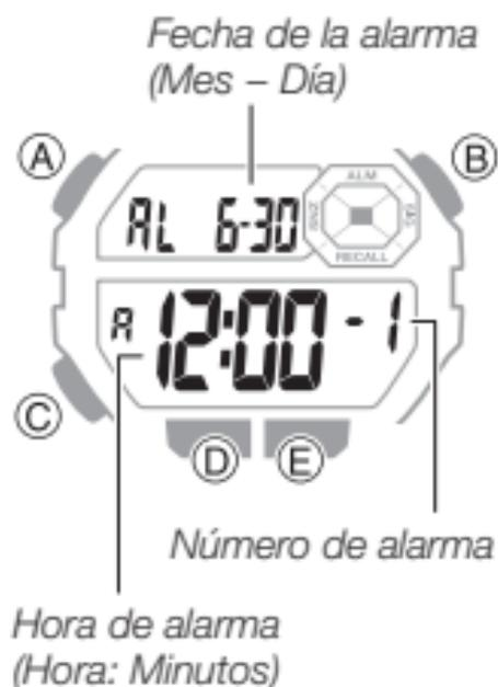
Puede configurar hasta tres alarmas multifunción independientes con la hora, minutos, mes y día. Cuando se activa una alarma, el tono de alarma suena cuando llega la hora de alarma. Una de las alarmas cuenta con función de repetición.
