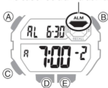
1. En el modo de alarma, utilice **(D)** para seleccionar la alarma número **2** o **3**.
