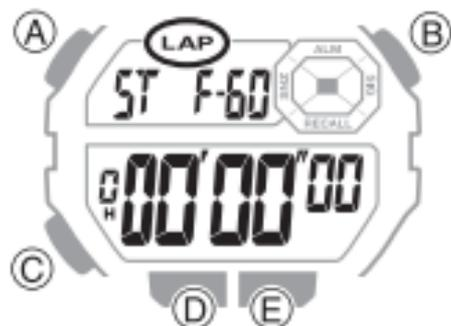
1. Cuando la pantalla del cronómetro muestre todos ceros, presione **(E)** para visualizar la pantalla del tiempo de vuelta (indicado mediante **LAP**).
