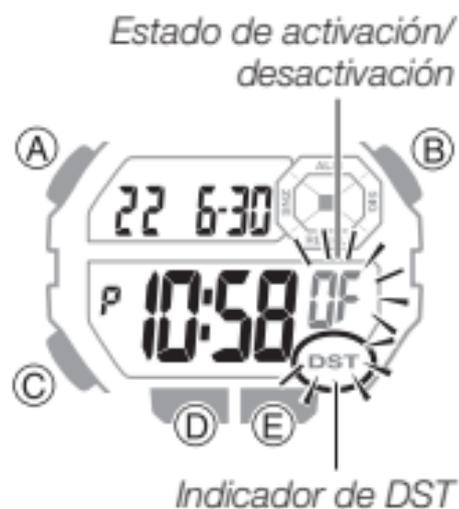
1. En el modo de indicación de la hora, mantenga presionado (A) hasta que los segundos comiencen a destellar, indicando que está en la pantalla de ajuste.
