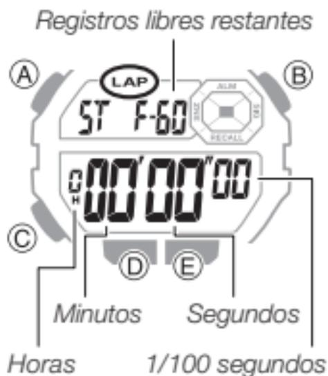
El cronómetro le permite medir el tiempo transcurrido, los tiempos de vuelta, los tiempos fraccionarios y dos tiempos de llegada. Los tiempos de vuelta y los tiempo fraccionarios se pueden almacenar en la memoria.
