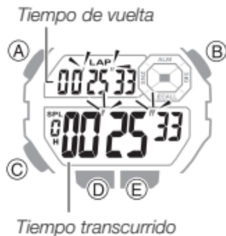
1. Cuando la pantalla del cronómetro muestre todos ceros, presione **(E)** para visualizar la pantalla del tiempo fraccionario (indicado mediante **SPL**).
