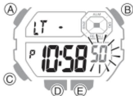
1. En el modo de indicación de la hora, mantenga presionado (A) hasta que los segundos comiencen a destellar, indicando que está en la pantalla de ajuste.
