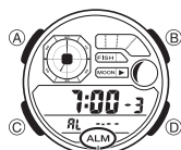
Indicador de alarma activada
