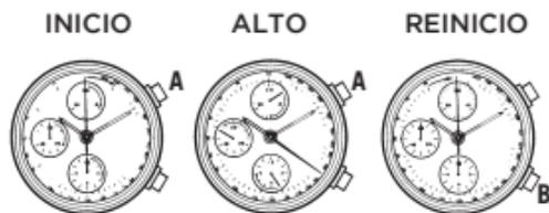
3. Para utilizar el iconografía, pulse una vez el botón situado a las 2 horas. El segundo contador comenzará a contar. Para detener el cronógrafo en cualquier momento, pulse de nuevo el botón situado a las 2 en punto.
