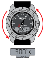
a) Gire hacia la izquierda el eje 6 h-12 h para alinear las 12 h con la dirección acimutal.
