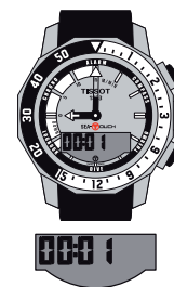
Modo Inmersión activo – Tiempo transcurrido en LCD, la aguja de los minutos indica en el bisel la profundidad en metros o pies, la aguja de las horas indica en la esfera la velocidad de inmersión en m/min o pies/min
