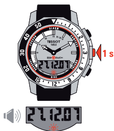
Activación del cristal (fuera del agua)
