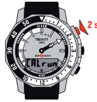
Activación del modo Calibrado – El cristal se desactiva durante el calibrado
