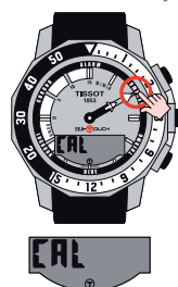
Calibrado de la brújula por el usuario
