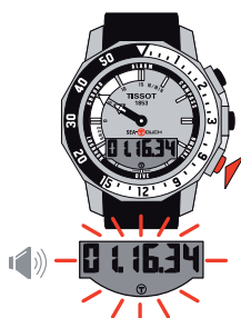
a) Parada con parpadeo, visualización del tiempo intermedio; el cronógrafo pasa a segundo plano
