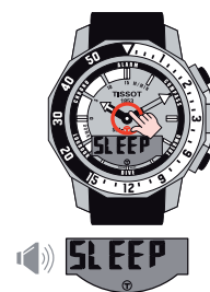
Activación automática del modo Pausa transcurridos 10 segundos Alarma acústica cada segundo
