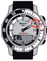
Visualización del calibrado de la brújula
