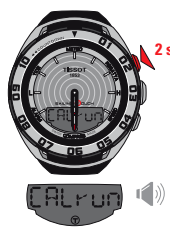
Activación del modo calibración : desactivación del cristal durante la calibración
